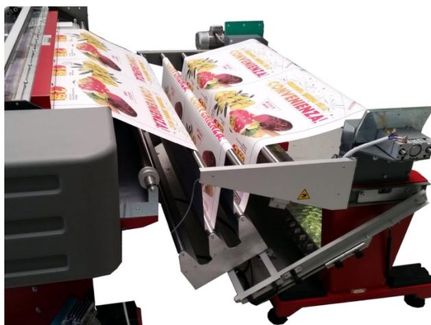
**Figura 5.** Alimentador de Fotoba™ compatible con los ejes de división HP Latex 3500/3600
