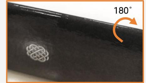
**TIP:** Las láminas de cartón corrugado y comprimido se pueden doblar 180° sin romper la tinta o dañar el sustrato. Sin embargo, las cartulinas, incluso laminadas, no pueden doblarse más de 90° debido a la menor flexibilidad del sustrato.
