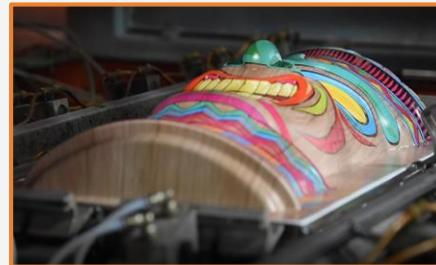
7. Termoformar la muestra impresa
