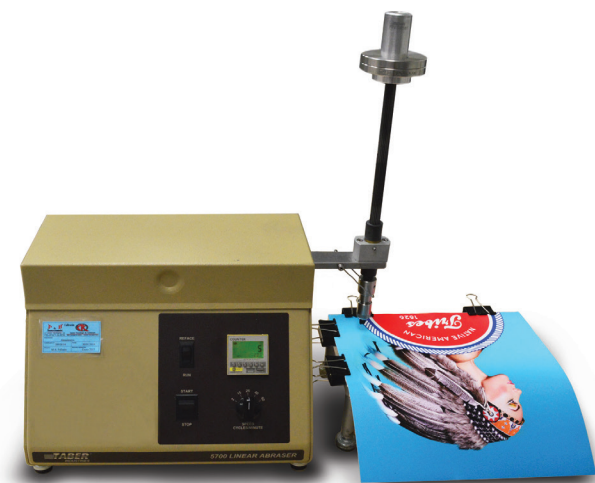
図 1 耐擦過性および耐摩耗性は、テーバー式磨耗試験機を使用し、業界の標準試験方法に沿って、検証しています 5 。
